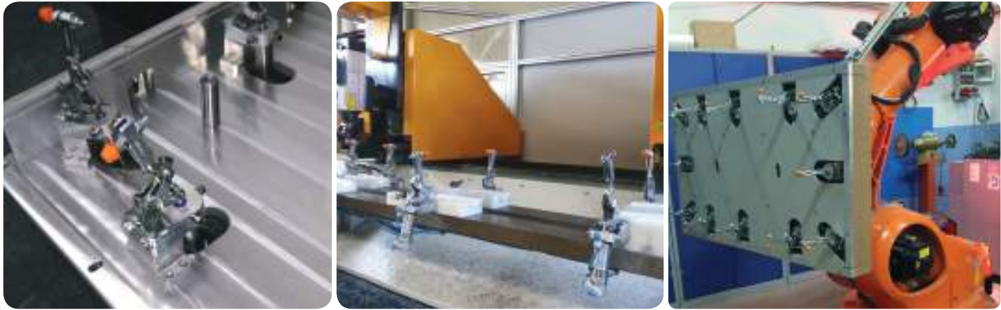
A pneumatikus hengerek oda-vissza működésűek, mágnesesek és párnázottak. Pneumatic cylinders are double acting, magnetic and cushioning
