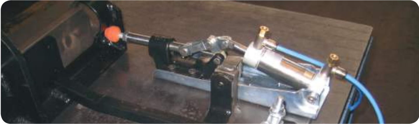
A pneumatikus hengerek oda-vissza működésűek, mágnesesek és párnázottak. Pneumatic cylinders are double acting, magnetic and cushioning.
