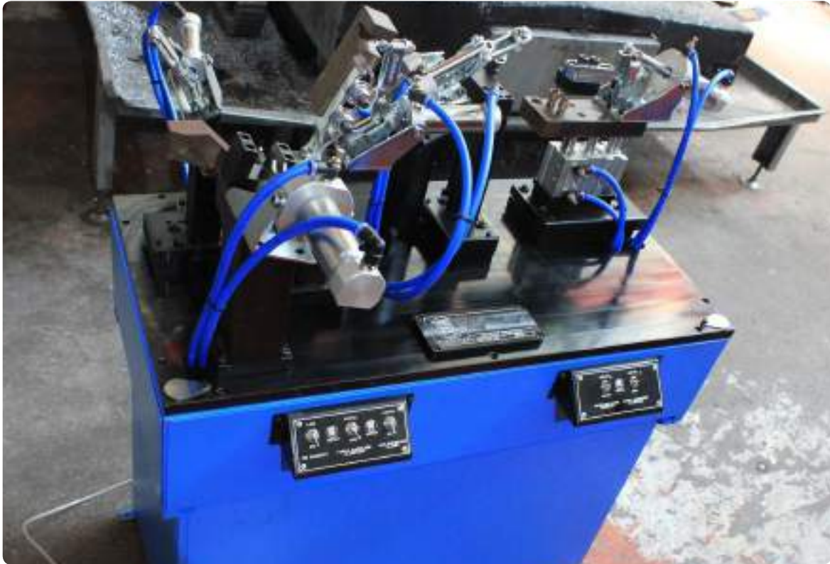
A pneumatikus hengerek oda-vissza működésűek, mágnesesek és párnázottak. Pneumatic cylinders are double acting, magnetic and cushioning
