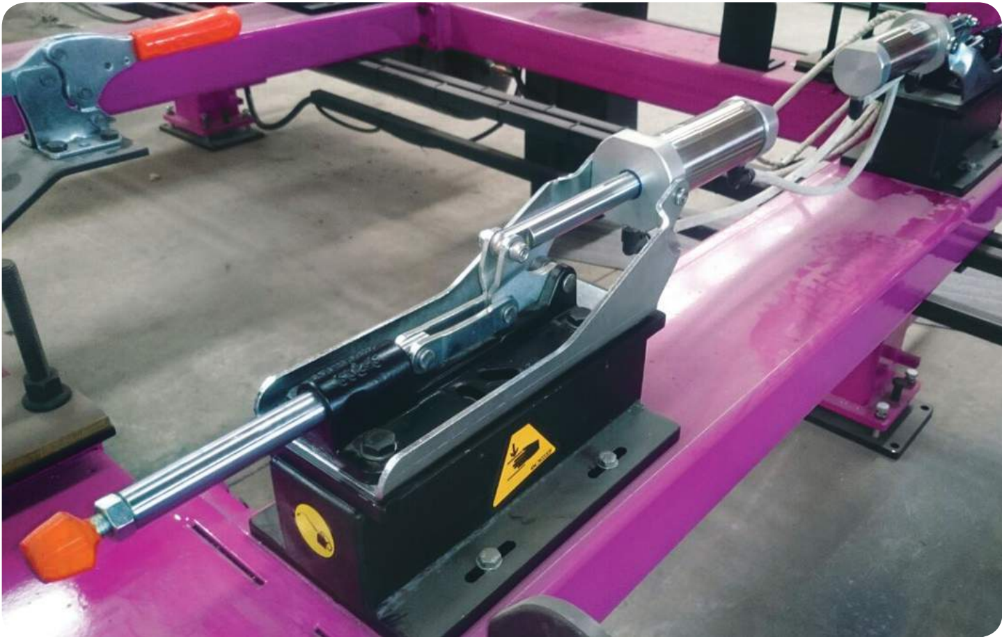
A pneumatikus hengerek oda-vissza működésűek, mágnesesek és párnázottak. Pneumatic cylinders are double acting, magnetic and cushioning
